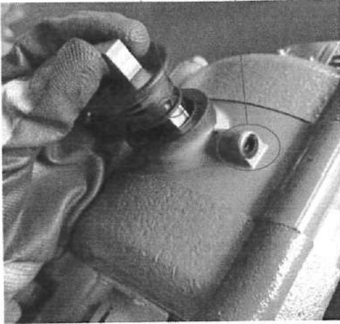
将无磁松闸杆插入制动器内，注意松闸杆凹点与制动器固定螺钉孔方向一致。
